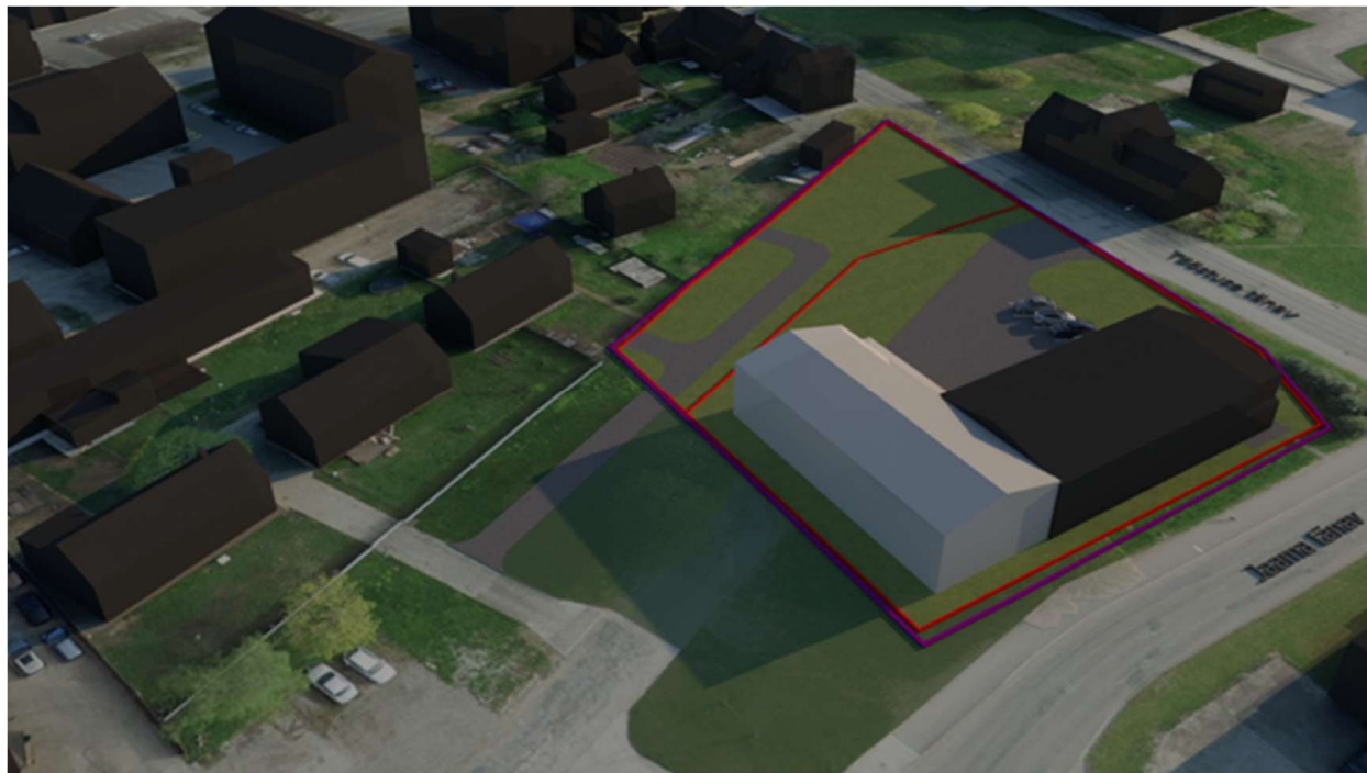
Joonis 2. Insolatsiooni analüüs, simulatsioon 22. aprill kl 7.00
